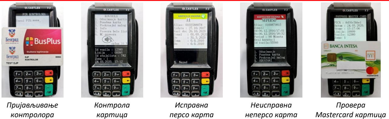
Слика 48. Изглед екрана преносног (PDA) уређај за контролу карата за различите функционалност
