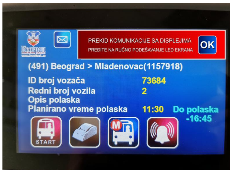
Слика 110. Изглед екрана возачког рачунара у ситуацији кад не постоји комуникација између возачког рачунара (DC) и контролне јединице за управљање LED екранима (CU)
